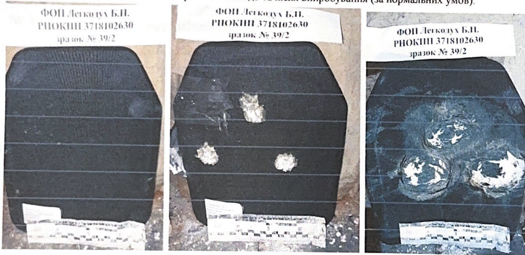
Фото 1.1.2. Зразок № 39/2 до та після випробування (за нормальних умов).
