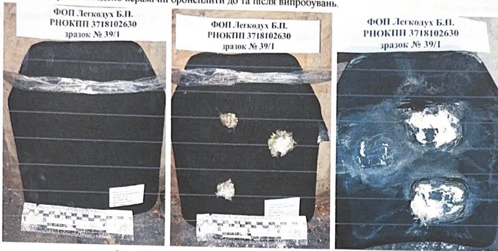
Фото 1.1.1. Зразок № 39/1 до та після випробування (за нормальних умов).
